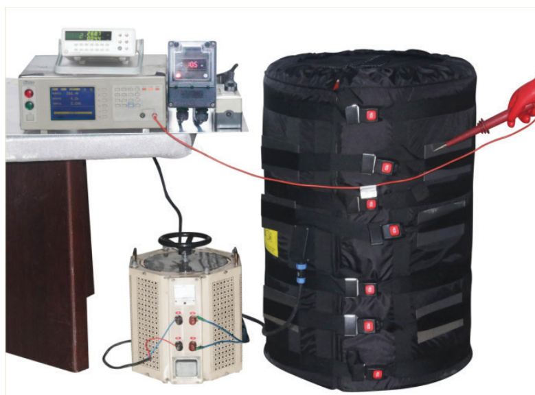
Messgeräte für den Gesamtableitstrom im heißen Zustand
