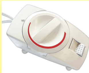
1995: Eine amerikanische Leistungsmesser-Heizdecke, ähnlich der, die mehr als 50 Jahre zuvor von Cook 1942 entwickelt wurde. Außenansicht und Blick auf das innere Bimetall hat einen langsamen Unterbrecher mit vorweggenommenem Widerstand. Die einzige bemerkenswerte Entwicklung dieses Modells ist der Einbau eines Rauschfilters. (Ultimheat-Sammlung)
