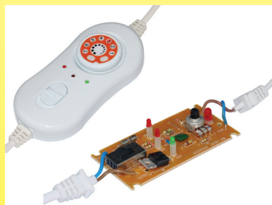
2019 Kontinuierliche elektronische Leistungsregelung Gummituch-Regelgerät (Ultimheat-Sammlung)
