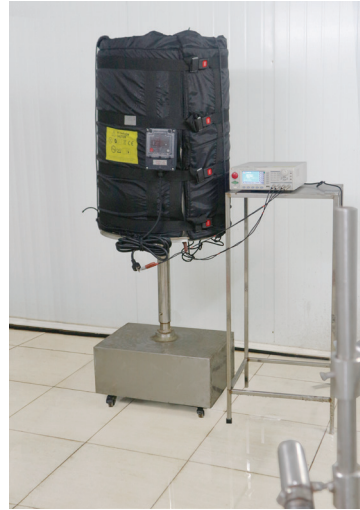
Messung des Isolationswiderstands nach IPx6-Tests
