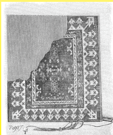
Innenansicht der Heizmatte, oben links - vom Strom durchflossene Drähte, unten rechts - Steckdose (1904, La Nature, Ultimheat-Sammlung)
