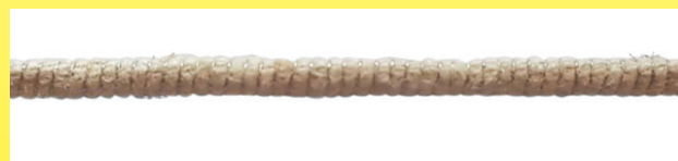
Ca. 1960. Calor-Heizschnur, Durchmesser 1,7mm, einfacher Nickel-Chrom-Heizdraht, Durchmesser 0,08mm, auf einer leicht gedrehten Baumwollseele, um ein Knicken zu verhindern (Ultimheat-Sammlung)
