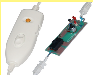
2019 Kontinuierliche elektronische Leistungsregelung Gummituch-Regelgerät (Ultimheat-Sammlung)
