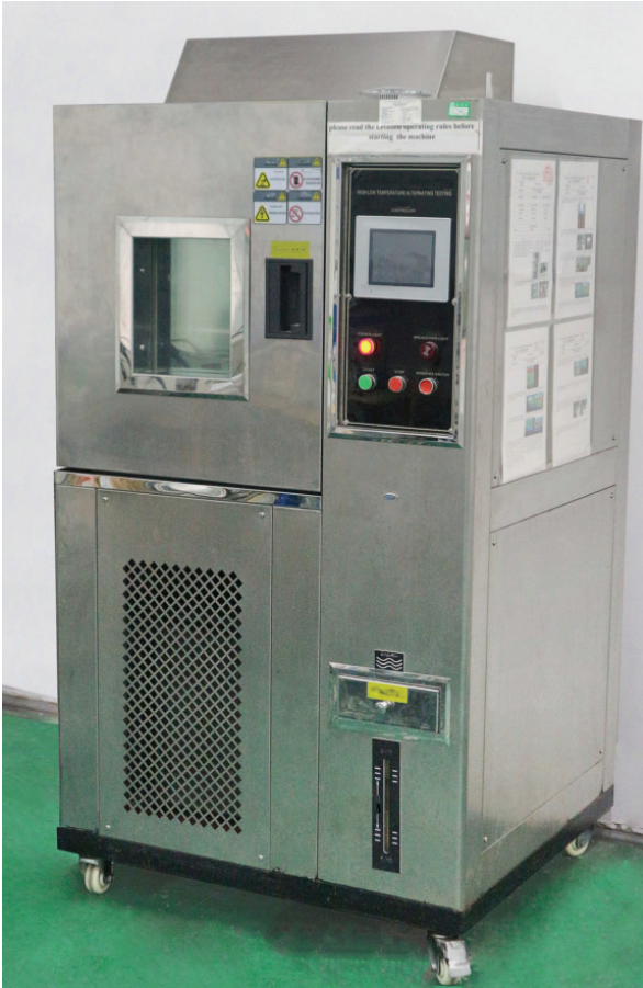
Klimakammer, mit Temperatureinstellbereich von -90 bis +150^\circ\text{C} , Einstellbereich der relativen Luftfeuchtigkeit 1 bis 100%
